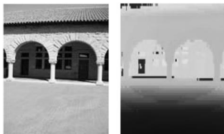
Рис. 1. Исходное изображение (слева) и восстановленная карта глубины (справа). Яркость пикселей на изображении справа означают расстояния до соответствующих объектов (ярче – дальше)
